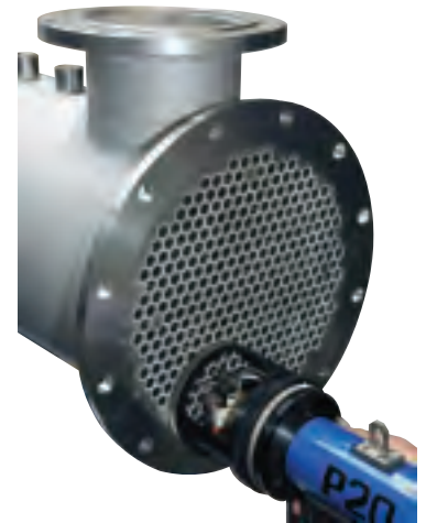
Automatisiertes Schweißen des Rohrendes und 100% Kontrolle.
